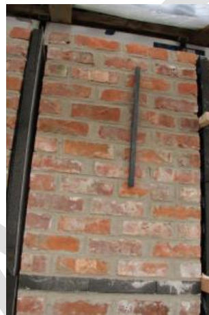
Figuur 27: Uitvoering van de muurankers in de testopstelling
