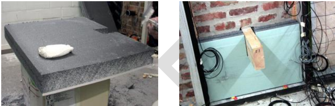
Figuur 16: Geprefabriceerd binnenisolatiesysteem op basis van een grijs EPS, gelijmd op de muur met een gipslijm
