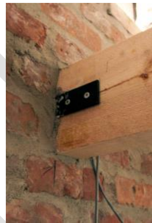
Figuur 27: Uitvoering van de muurankers in de testopstelling
