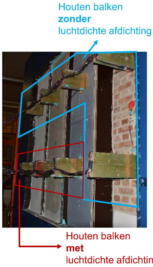
Figuur 4. (a) Tussenstuk met houten balken en aanduiding van balken zonder luchtdichte aansluiting (b) en met luchtdichte aansluiting.
