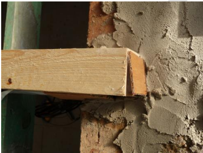
Figuur 15: Luchtvoeg (boven) en mortelvoeg (onder) bij opbouw van muren in de testopstelling
