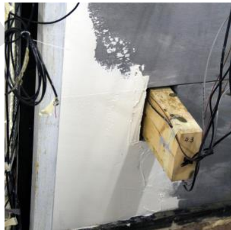
Figuur 19: Binnenisolatiesysteem op basis van het capillair actief calciumsilicaat, afgewerkt met een dampopen pleisterlaag.
