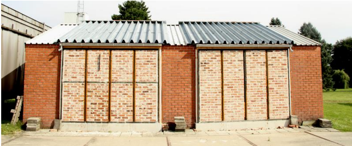
Figuur 13: Testopstelling op het proefstation van het WTCB, bestaande uit twee kamers waarin verschillende testwanden gebouwd werden. De wanden zijn onderworpen aan de buitenomstandigheden.
